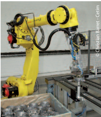
Le robot "dévraqueur" sélectionne une pièce parmi une multitude dans des conditions de "semi-vrac".
